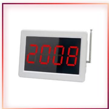
Устройство iBells-109 представляет собой табло, предназначенное для отображения вызовов, поступающих от подключенных к нему беспроводных кнопок.
